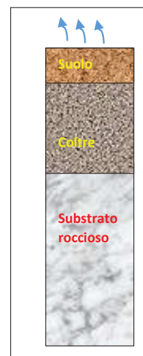
Fig. 2.2 - Stratigrafia del suolo: migrazione del radon dalla coltre superficiale e dal suolo
