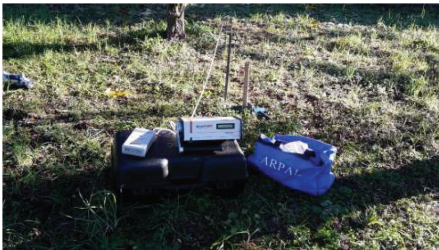
Fig. 2.3 - Assetto di misura della concentrazione di attività di radon nel suolo
